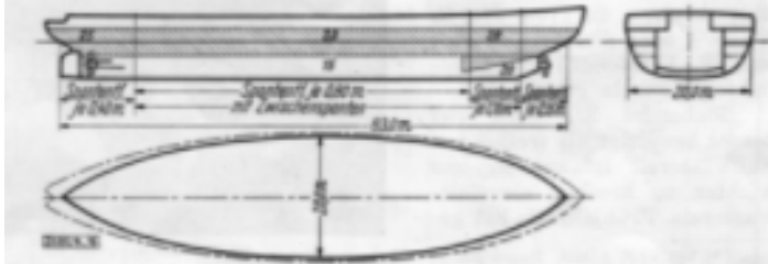
Bild 14 bis 16. Die kennzeichnenden Schiffsfornen der verschiedenen Eisbrecher.
